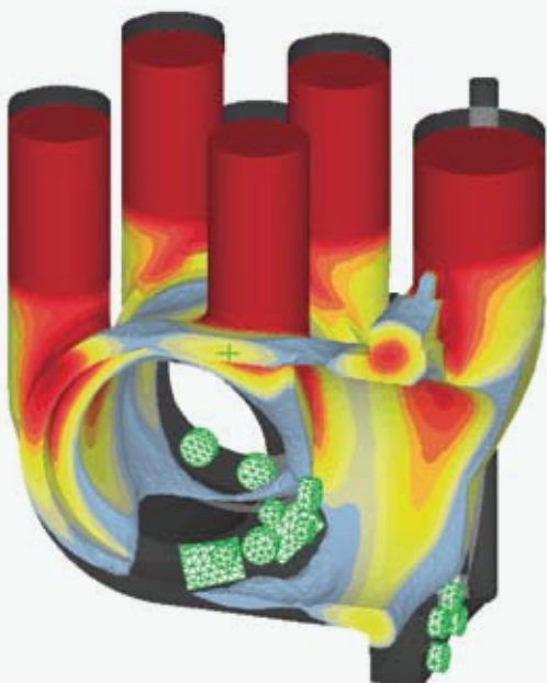
Рис. 3. Кристаллизация сплава в ProCAST
