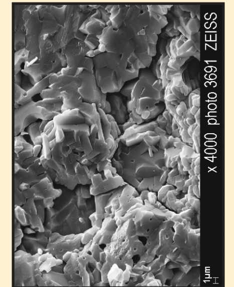
Рис. 7, 8, 9. Микроструктура общепромышленной керамики класса С795 при разном увеличении (резко неоднородная структура зерна, поры, трещины)
