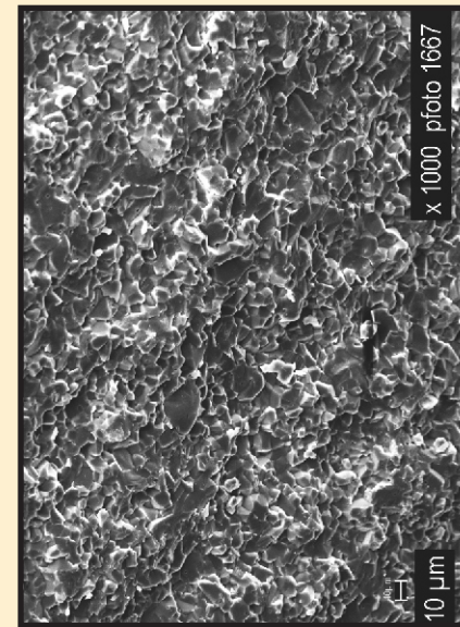
Рис. 4, 5, 6. Микроструктура керамики марки RAPAL при разном увеличении (однородная плотная структура зерен 3–10 мкм без включений)
