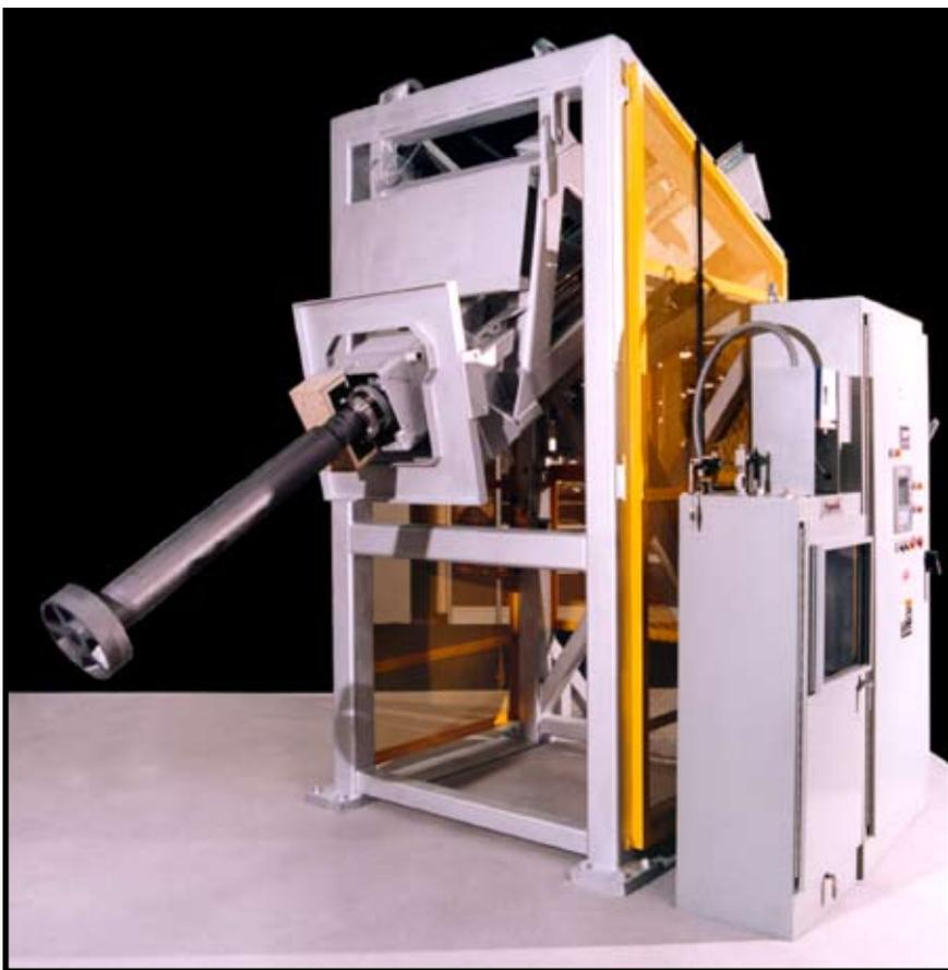
Система SNIF® HD-2000 обеспечивает автоматическую обработку металла в печи и является безопасной, эффективной альтернативой ручному использованию флюсовальных трубок.
