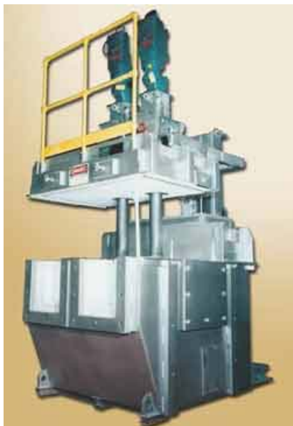
SNIF SHEER ™ P-60UHB система с дополнительн. подъемн. крышки в положении для обслуживания.
