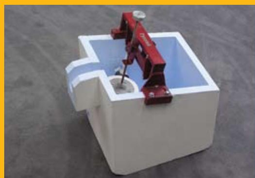
Рисунок 7 – Устройство для регулирования уровня металла
