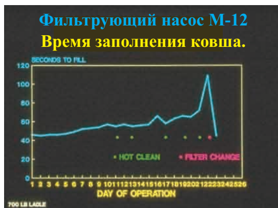
Транспортировочный насос Metaullics с фильтрующим основанием из связанных частиц.
