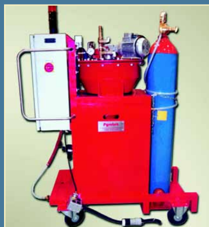
Портативный инжектор флюса FIF-50 или в комбинации с HD-2000
