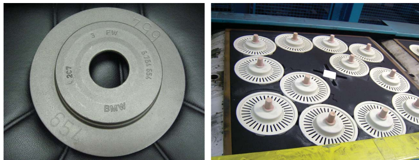
Рис.2. Вентилируемый тормозной диск легкового автомобиля BMW, полученный на одной из трех линии HWS-Sinto на заводе Fritz Winter, Германия, 12 отливок в одной опоке (3000 шт./час, производительность линии 250 форм в час)
