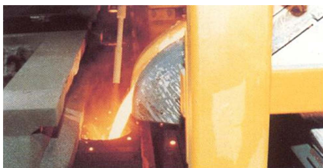
Рис.7. Процесс заливки с одновременной верхней подачей модификатора в формы с учетом их массы
