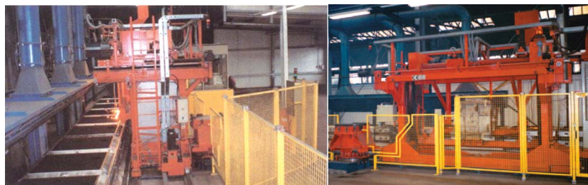
Рис.3. Заливочный автомат типа PA 10-S на действующей формовочной линии по СЕИЯТЦУ-процессу для заливки серого чугуна и чугуна с шаровидным графитом
