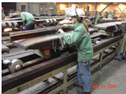
Рис.16. Проверка отливки на плоскостность
