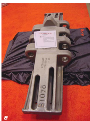
Рис. 8, а, б. Отливка «Трак гусеницы» транспортера: 1 – центральные гребни; 2 – пальцы сцепки
