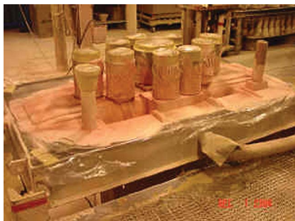
Рис.15. Модельные плиты для верхней и нижней полуформ
