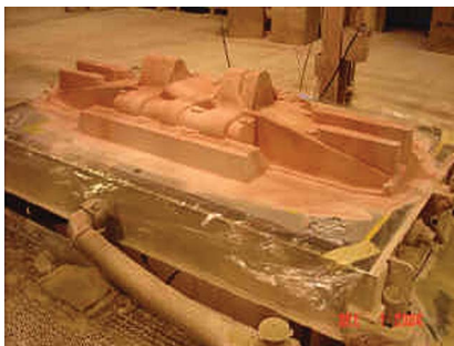
Рис.15. Модельные плиты для верхней и нижней полуформ
