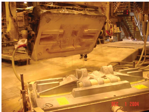
Рис. 13. Съем готовой полуформы с модельной плиты
