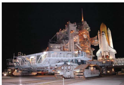
Рис.6. Транспортировка космического корабля «Шаттл» от ангара сборки до стартовой площадки
