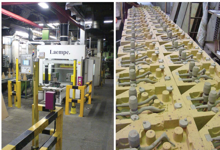
Рис. 4. Общий вид стержневого автомата LB25 (а) и стержневые блоки (б)
