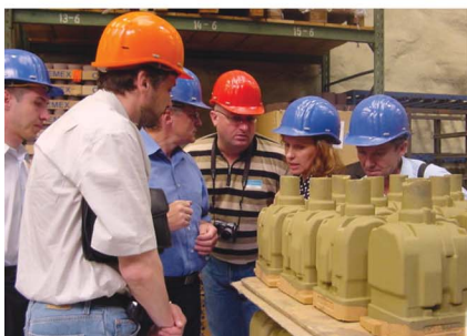
Рис. 6. Делегация российских специалистов на заводе Linde на участке изготовления стержней, изготовленных на машинах Laempfe (вверху стержневые знаки – остаток от вдувных сопел – рабочие поверхности идеальны)
