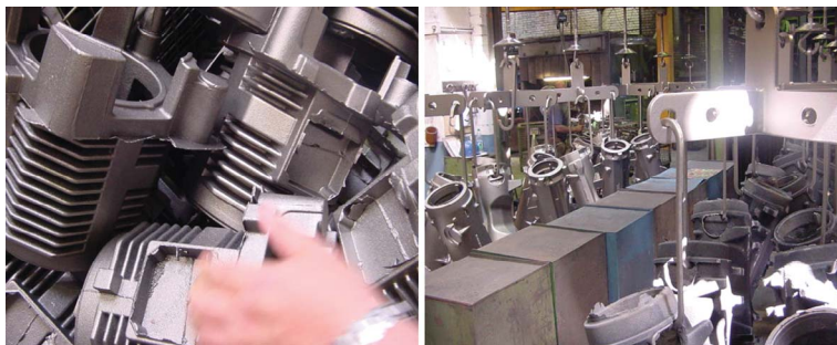
Рис. 3. Отливки для собственного производства завода Linde, полученные на двух формовочных линиях HWS с использованием стержней, изготовленных на машинах Laempfe
