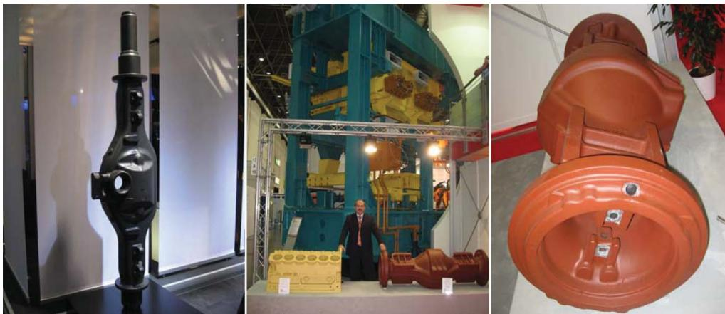
**Рис.15.** Отливки среднего и самого крупного заднего моста (материал: EN-GJL, масса 650 кг) завода Georg Fischer, Лейпциг на выставке GIFA -2007, Дюссельдорф, на фоне машины второй формовочной линии фирмы HWS-Sinto для МТЗ, Минск
