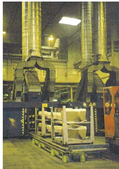
**Рис.14 .** Общий вид сушил и тележки со стержнями на входе печи
