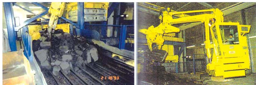
**Рис.7.** Манипулятор для извлечения отливок, удаления литниковой системы, кабина рабочего оборудована кондиционером
