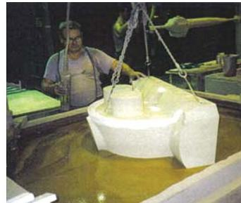
**Рис.13 .** Окрашивание стержня
