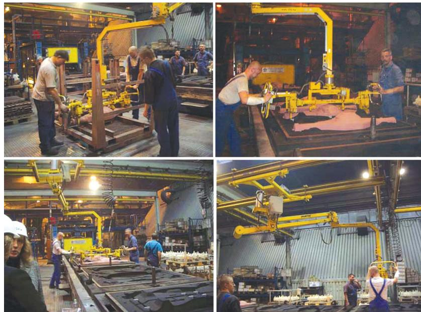
**Рис.6.** Установка крупных стержней с помощью схемы простейшего «пантографа» – свободное перемещение стержней через конвейер полуформ; контроль с двух сторон опоки по точности совмещения стержневых знаков
