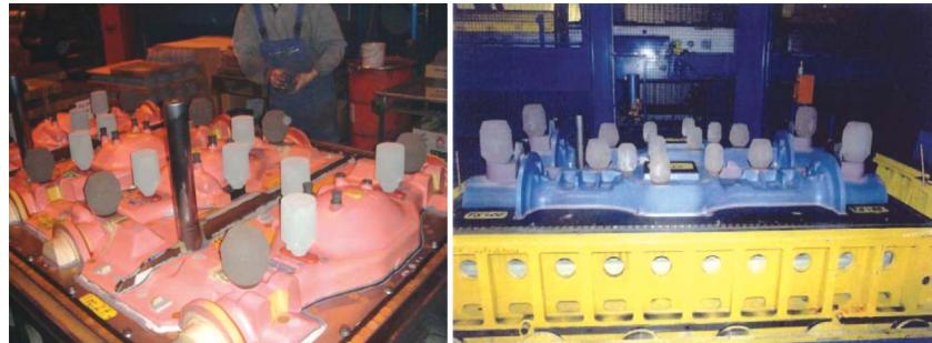
**Рис.9.** Модельные плиты для разных типов отливок «мост» и установка более 20 экзотермических прибылей, которые благодаря технологии уплотнения форм «Сейатцу» не разрушаются при прессовании
