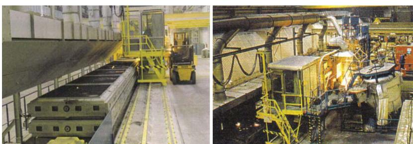
**Рис. 5.** Участок заливки форм с автоматическим разливочным устройством без подогрева
