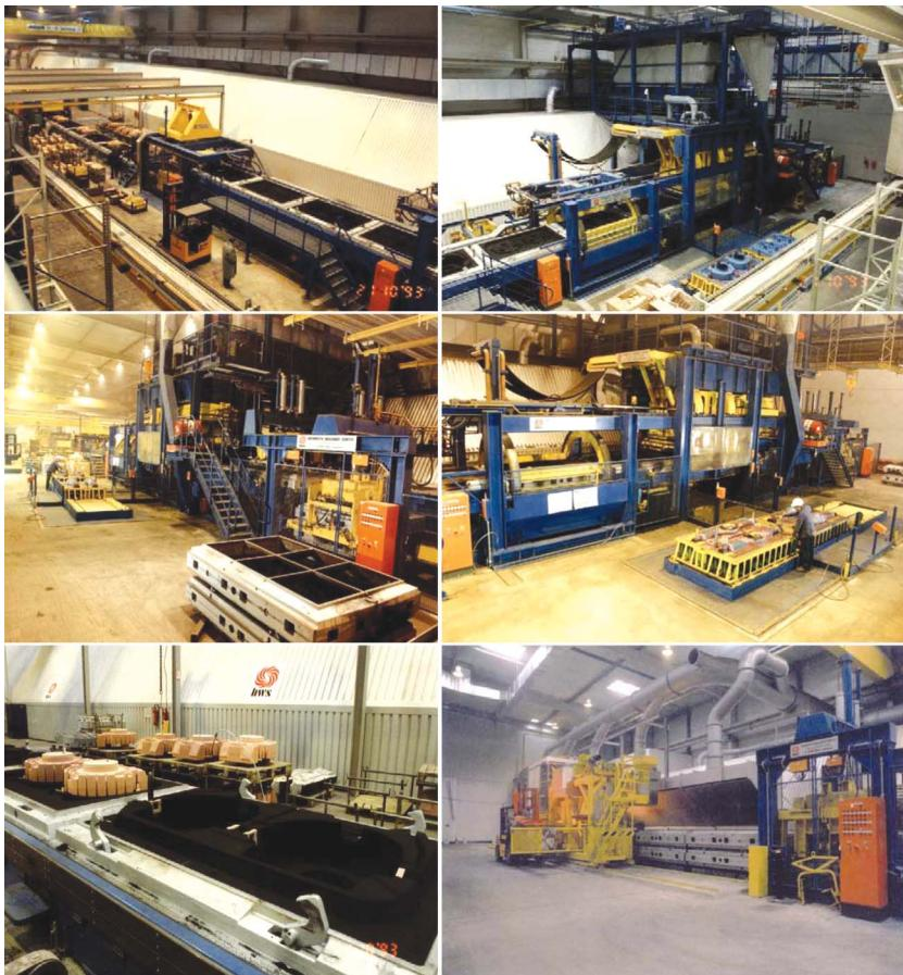
**Рис. 11.** Виды на отдельные участки формовочной линии – охлаждения, смены моделей, формовки, простановки стержней, заливки
