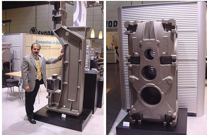
Рис.1. Крупные автоагрегатные отливки на стенде завода Georg Fischer, Лейпциг, на выставке GIFA-2003, Дюссельдорф, в специальном павильоне для поставщиков отливок
