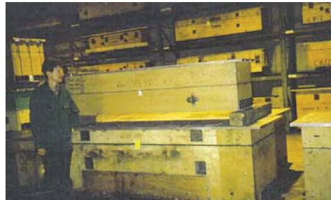
**Рис.12.** Массовое применение деревянных стержневых ящиков на заводе Georg Fischer, Лейпциг
