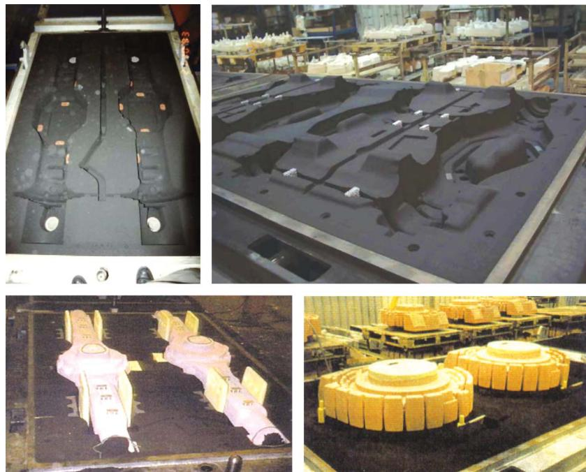
**Рис.10.** Полуформы низа без и с установленными стержнями
