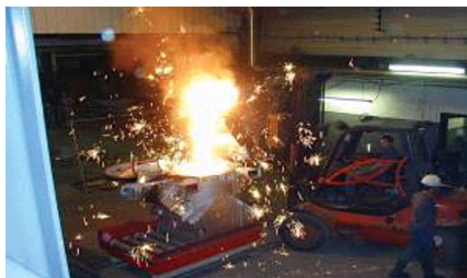
Рис.3. Использование вилочных погрузчиков для транспортировки жидкого металла
