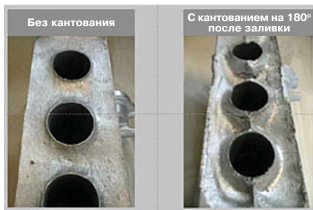
Рис. 10. Прибыль 40-кг алюминиевого блока двигателя на 4 цилиндра с различным расположением прибылей (слева – иллюстрация поведения расплава при заливке снизу без кантования, а справа – заливка снизу через прибыль с последующим кантованием)
