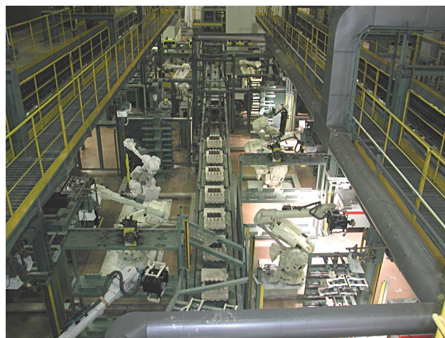
Рис. 2. Общий вид производственного участка производства стержней для получения отливок блоков 4-х цилиндровых рядных двигателей из алюминия на заводе Mazda Motors Co. Стержневая роботизированная линия фирмы Laempe
