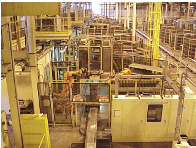
Рис. 1. Литейное производство Ford на базе 40 роботизированных стержневых комплексов Laempe
