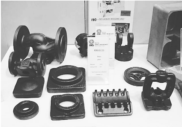
▲ Рис. 2. Отливки, полученные на оборудовании HWS методом воздушный поток плюс прессование на горизонтальной безопасной формовочной машине FBO-3S, завода “Зеткама”, Польша
