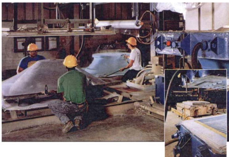
Рис. 6. Контроль верхней и нижней полуформ на линии вакуумно-пленочной формовки с размером опок 1370 x 2440 мм
