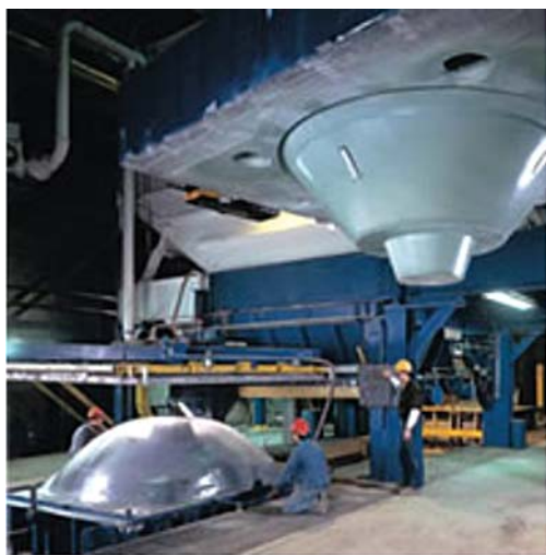
Рис. 5. Самая большая линия вакуумно-пленочной формовки завода Frog Switch, США
