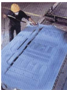
Рис. 7. Нанесение противопригарного покрытия на поверхность формы для улучшения поверхности отливок
