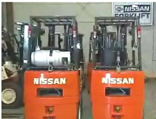
Внешний вид окрашенных и установленных литых противовесов
