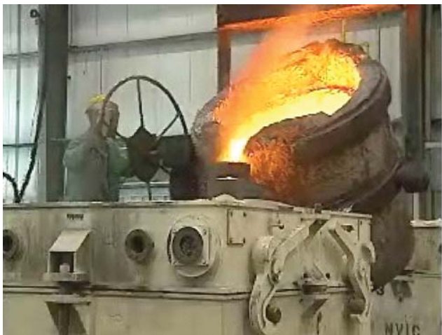
Заливка вакуум-пленочной формы. Сварные опоки с автоматическим скреплением «скобами» и простыми «лепестковыми» открытыми клапанами вакуумирования
