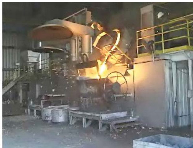
Заливка вакуум-пленочной формы. Сварные опоки с автоматическим скреплением «скобами» и простыми «лепестковыми» открытыми клапанами вакуумирования
