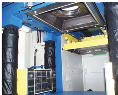
Рис. 5. Вид пескострельной головки стержневого автомата LFB25 – исполнение с вакуумной прокладкой. За отверстием головки – продувной механизм со встроенной верхней толкательной плитой. Под головкой – стол машины с боковыми прижимными механизмами. Направляющие колонны машины защищены от засорения резиновыми чехлами
