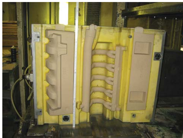
Рис. 8. Общий вид смонтированного на стержневом автомате Лаемпе L40 3-х гнездного стержневого ящика с вертикальным разъемом
