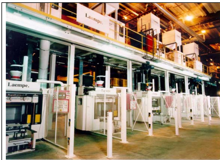
Общий вид стержневого участка по производству стержней для головок цилиндров на заводе Cosworth Castings в г. Вустер, Великобритания, оснащенный стержневыми автоматами Laempe
