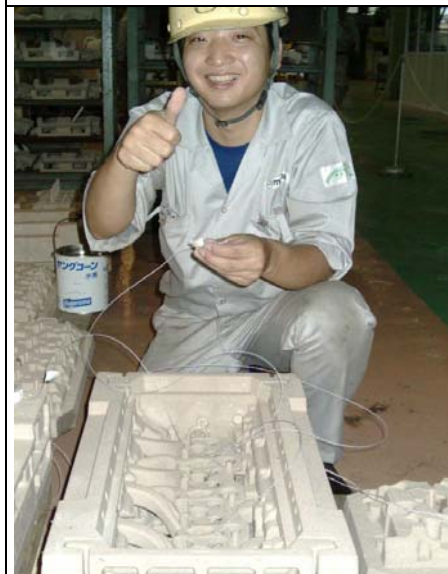
Отработка технологии изготовления стержневых пакетов по методу BeachBox для получения головки цилиндров 4-х цилиндровых двигателей на автомобильном концерне MAZDA .
