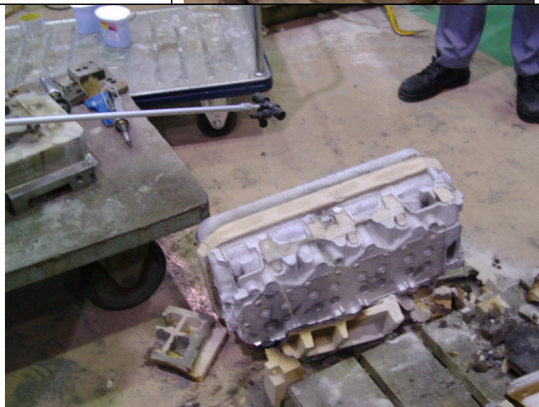
Отработка технологии изготовления стержневых пакетов по методу BeachBox для получения головки цилиндров 4-х цилиндровых двигателей на автомобильном концерне MAZDA .
