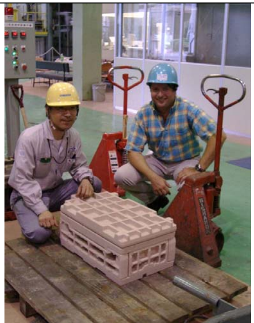
Отработка технологии изготовления стержневых пакетов по методу BeachBox для получения головки цилиндров 4-х цилиндровых двигателей на автомобильном концерне MAZDA .
