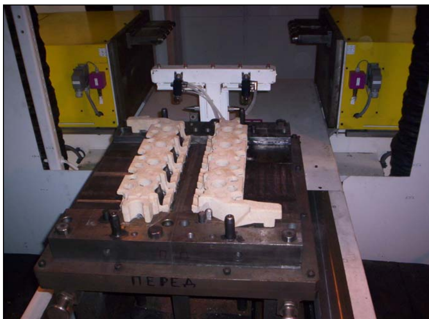
Производство стержней типа водяной рубашки головки цилиндров на машинах Laempe типа LB50 в условиях «Заволжского Моторного Завода»
