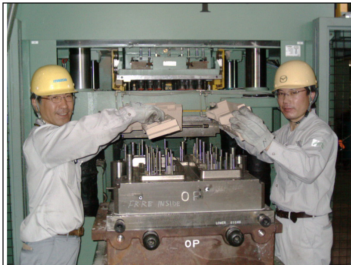
Отработка технологии изготовления стержневых пакетов по методу BeachBox для получения головки цилиндров 4-х цилиндровых двигателей на автомобильном концерне MAZDA .
