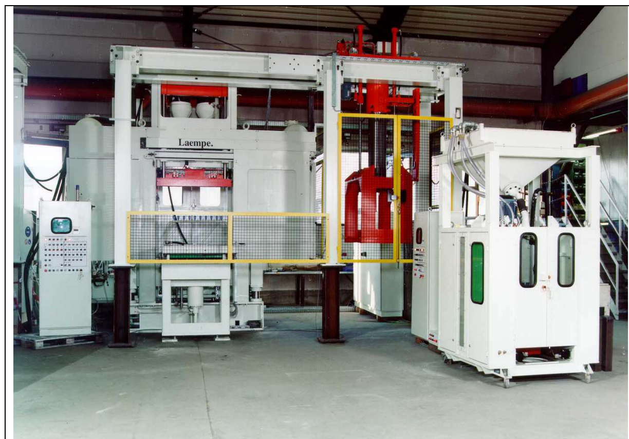
Общий вид пескострельного центра Laempe на заводе «Миочи»
