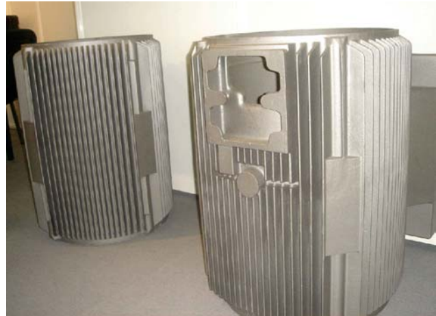
Рис.1. Отливки «Корпус электродвигателя» (без дополнительной механообработки между ребрами) высотой 900 мм, изготовленные по «Сейатцу»–процессу в «сырых» песчано–бентонитовых формах. Отливки изготовлены без внутреннего стержня и без стержней для боковых ребер. Отливки не имеют видимых следов по плоскости разъема форм при вертикальном расположении отливок в формах
