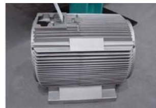
Рис. 6. Отливка «Корпус электродвигателя», диаметр 700 мм, формовочный уклон ребер 0,25°. Изготовлена на формовочной линии HWS–Синто, размер опок 1500x1100x500/500 мм
