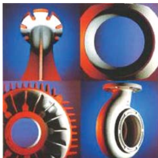
Рис. 7. Отливки корпусов электродвигателей, насосов, арматуры самой разнообразной номенклатуры, изготовленные на одной формовочной линии с автоматической заменой оснастки в такте работы линии
