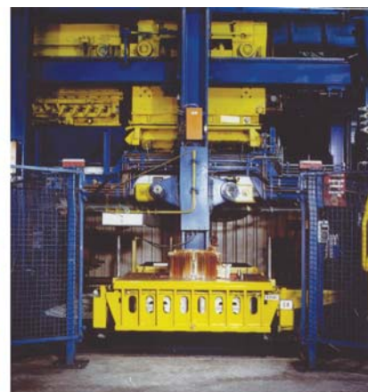
Рис. 16. Модельная плита, держатель модельной плиты, рабочий стол формовочного автомата с модельной оснасткой на современных линиях HWS–Синто
