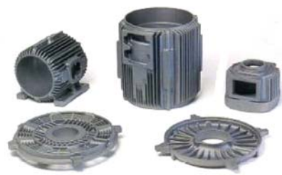
Рис. 7. Отливки корпусов электродвигателей, насосов, арматуры самой разнообразной номенклатуры, изготовленные на одной формовочной линии с автоматической заменой оснастки в такте работы линии
