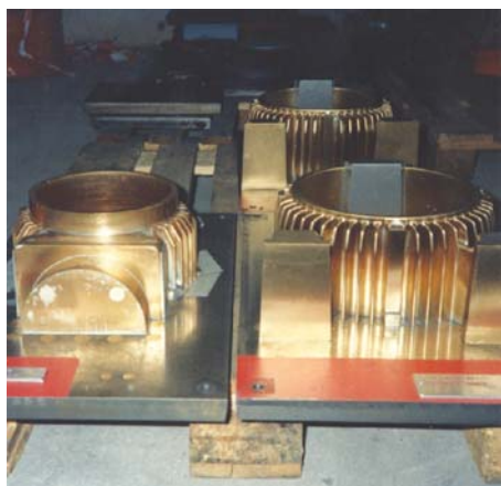
Рис. 16. Модельная плита, держатель модельной плиты, рабочий стол формовочного автомата с модельной оснасткой на современных линиях HWS–Синто
