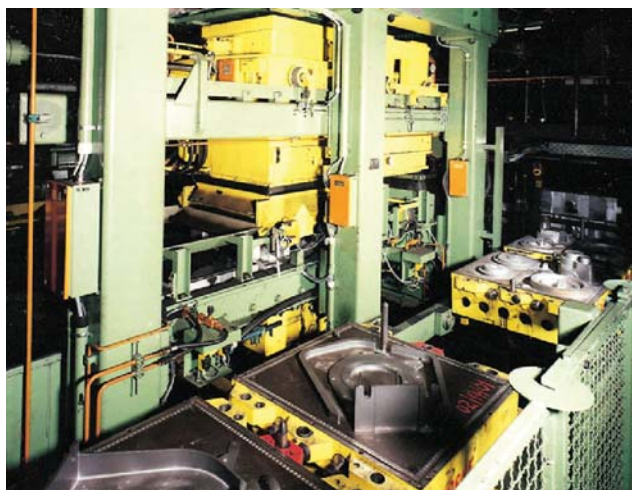
Рис. 14. Изготовление отливок на линии HWS–Синто
