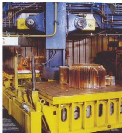
Рис. 16. Модельная плита, держатель модельной плиты, рабочий стол формовочного автомата с модельной оснасткой на современных линиях HWS–Синто
