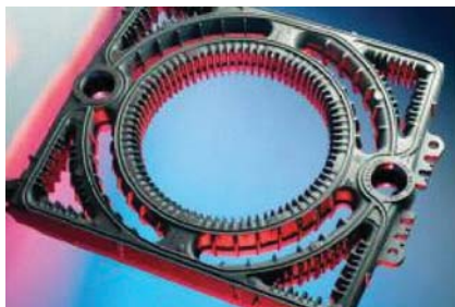
Рис. 8. Сложные тонкостенные (до 4 мм) отливки секций корпусов котлов, изготавливаемые в параллельном режиме с корпусами электродвигателей на одной автоматической формовочной линии фирмы HWS–Синто
