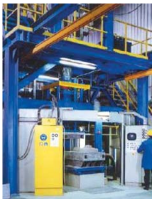
Рис. 11. Стержневая машина фирмы Laetpre (а) и простановка стержней на автоматической формовочной линии фирмы HWS–Синто (б)
